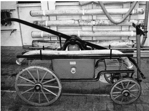
Typische Handdruckspritzpumpe aus der ersten Hälfte des 19. Jahrhunderts
